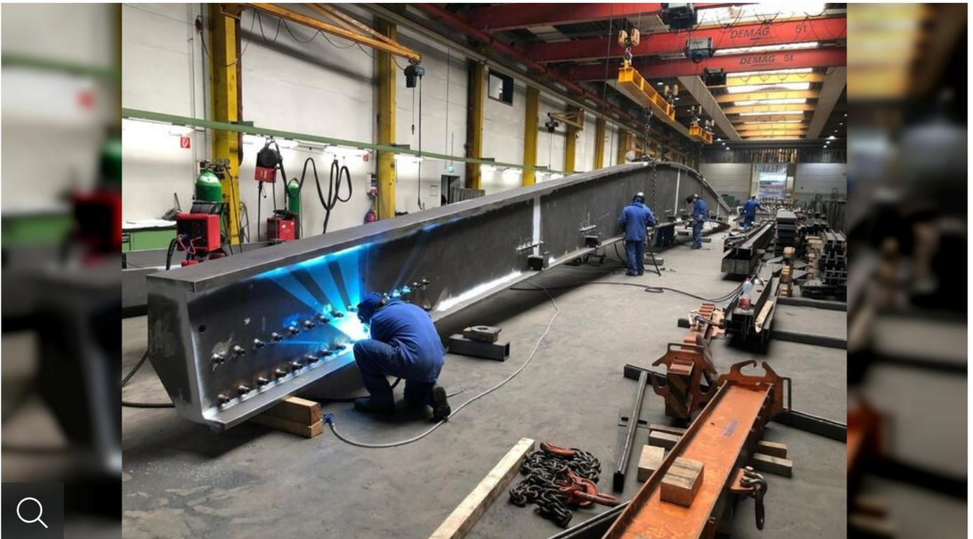
Der Hauptträger der Stahlkonstruktion wird beim Zulieferer in Wangen zusammengebaut. (Foto: Stadtverwaltung)
