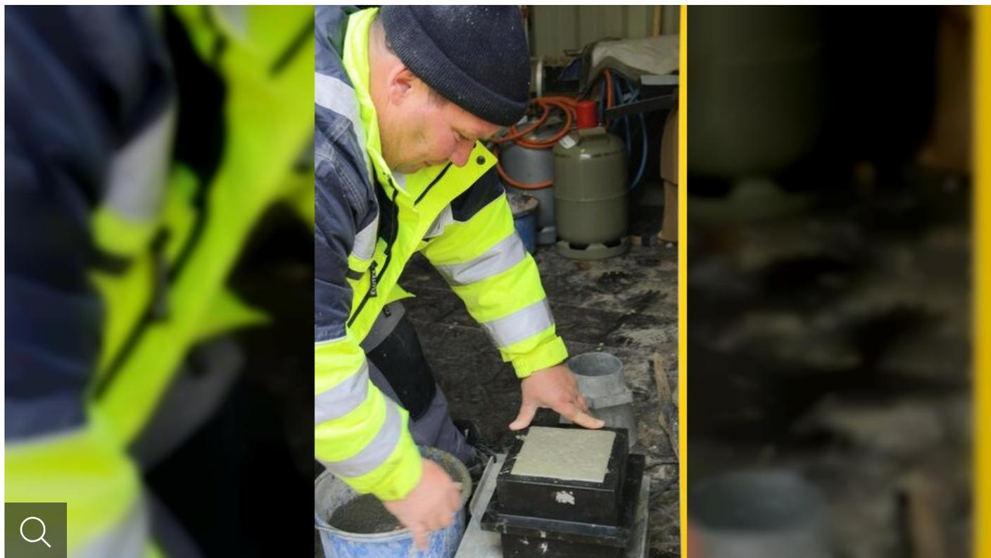
Für die Dokumentation muss Hubert Sauter eine Probe des Betons gießen. (Foto: Marion Buck)
